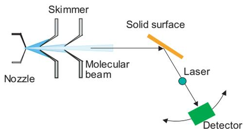
Fig. 5 面・分子線干涉実験装置概略
